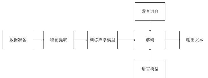
上图展示了基于Kaldi的语音识别的流程，如图所示除了最后的输出文本外基于Kaldi 的语音识别系统，总共包括6步，其中绝大多数步骤融合在Kaldi的脚本中（特征提取，训练声学模型，解码）。所以用哈萨克语的输入及输出搭建语音识别系
